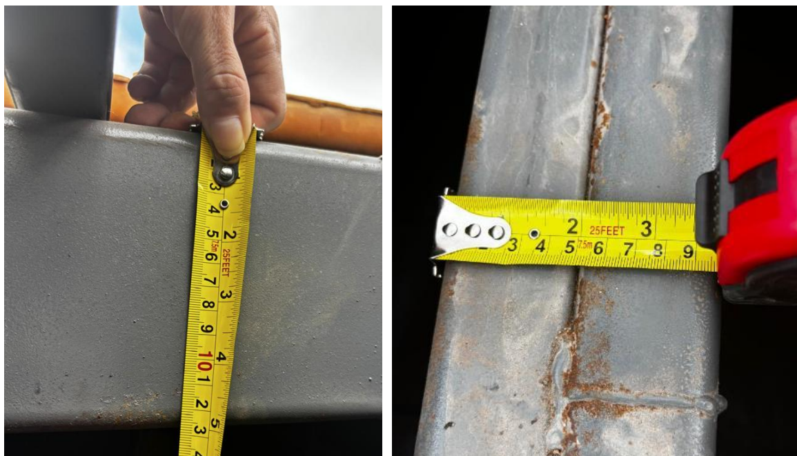
Figura 16 – As imagens mostram a medição das dimensões dos perfis das tesouras realizada in loco com trena manual, a fim de verificar se os elementos executados em campo correspondem ao especificado no projeto “As Built”.
